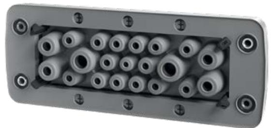
С помощью стопорных крючков KES-GB цепляется за стенку корпуса снаружи, а изнутри привинчивается через стенку корпуса встроенными резьбовыми втулками.
